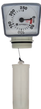
Art. 400412 Mechanische Schwimmerstandsanzeige mit analoger Anzeige. Steckeranschluss 1 " -1/2 G. Skala in cm von 0-250.
